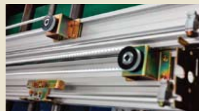
耐食性、耐摩耗性が向上したステンレス上レールとウレタンタイミングベルト
