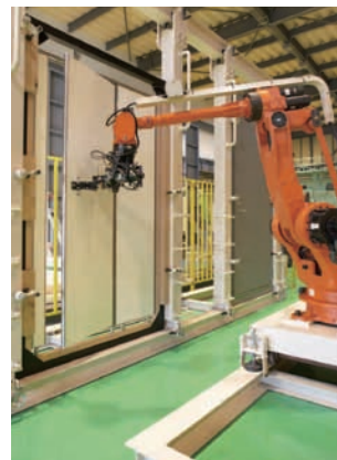
▶ ドア開閉繰り返し試験装置
