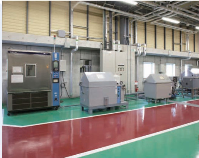
▲左から恒温恒湿槽、塩水噴霧試験機、複合サイクル試験機
