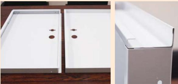
パネルベンダーシステムで曲げ加工したドア(断面)
