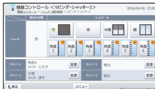
電動窓シャッター 個別詳細操作画面
