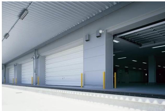
このたび発売する「耐風ガードOSD」は、最大4500Paの耐風圧強度(風速85.7m/秒相当)を確保したオーバースライダーです。オーバースライダーは天井に設置したガイドレールにパネルをスライドさせて開閉する機構のパネルシャッターで、スピーディーな開閉操作はそのままに、パネルやローラ軸の構造を見直すことでの耐風圧強度を向上させました。また、耐風圧強度4500Paにおける設計範囲の最大 W(幅)は8.3mまで対応し、業界最大<sup>※2</sup>の開口幅を確保しています。(耐風圧強度2000Paの場合、最大W(幅)は11.1mまで対応)
